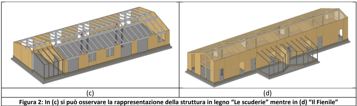
Figura 2: In (c) si può osservare la rappresentazione della struttura in legno “Le scuderie” mentre in (d) “Il Fienile”
